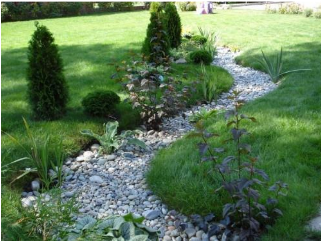
Малюнок 1. Приклад відведення води з доріжки парку на траву природнім способом
